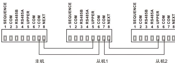
可以将多台时序器进行级联使用，按上图接线图示连接多台时序器，此时第一台时序器为控制主机（主界面显示标志：[主机]），当启动主机的序列开关（Sequence），在主机通路序列开启后，从机（主界面显示标志：[从机]）的通路依次开启。在级联状态下，请关闭所有从机的定时启动功能。
