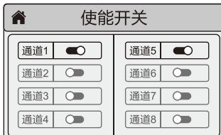
通道1~8使能开关，当该通道处于关闭状态时灰色不受智能开启和关闭的控制；
