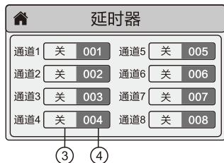
打开延时器菜单，可以设置该通道延时开启/关闭的时间，触摸输入参数或旋转MENU键进行参数设置，可设置时间范围均为0~999s；
