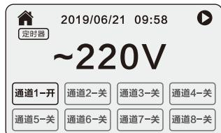
打开定时器菜单，可以设置一个或多通道定时开启/关闭的时间，可选单次/循环，触摸输入参数，可设置10个定时器，当设备开启定时器时，主界面会显示“(定时器)”；
